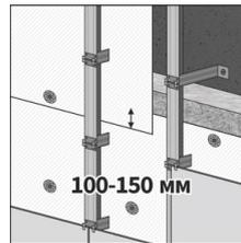
**2.** Монтаж ведётся горизонтальными полотнами снизу вверх. Горизонтальные и вертикальные **нахлёсты составляют минимум 100 мм.**
