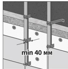
**4.** Со стороны фасада необходимо смонтировать вентиляционный **зазор не менее 40 мм** для удаления влаги из утеплителя. Выполнить конструкцию фасадной системы, позволяющую обеспечивать необходимую вентиляцию.
