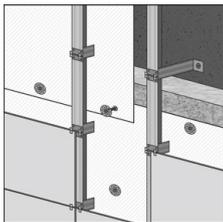
**3.** Крепление плёнки выполняется при помощи тарельчатых дюбелей согласно схеме проекта. **Минимальное расстояние от края полотна до точки крепления составляет 50 мм.** Материал должен быть закреплён вплотную к утеплителю без зазоров или провисов.
