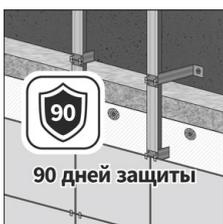
**5.** Плёнка может служить защитой утеплителя на стенах в течение **90 дней** до монтажа наружной отделки.
